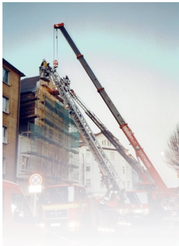
FEUERWEHRKRAN KW 40 * ROEPNAAM Florian Dortmund 01 KW 01 * KENTEKEN DO-2010 * BOUWJAAR 1994 * MERK Liebherr Mobilkran LTM 1040/1 * VERMOGEN 230 kW (312 pk) * CILINDERINHOUW 9.960 cm³ * AANDRIJVING 6x4x6 * BRUTO VOERTUIGGEWICHT 36.000 kg * LENGTE 10,97 m * BREEDTE 2,50 m * HOOGTE 3,62 m * MAXIMAAL LAADVERMOGEN 40 ton * MAXIMAAL REIKWIDTE 30 meter * MAXIMALE SNIJDE 70 km/u
