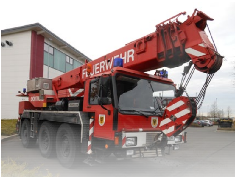
FEUERWEHRKRAN KW 40 * ROEPNAAM Florian Dortmund 01 KW 01 * KENTEKEN DO-2010 * BOUWJAAR 1994 * MERK Liebherr Mobilkran LTM 1040/1 * VERMOGEN 230 kW (312 pk) * CILINDERINHOUW 9.960 cm³ * AANDRIJVING 6x4x6 * BRUTO VOERTUIGGEWICHT 36.000 kg * LENGTE 10,97 m * BREEDTE 2,50 m * HOOGTE 3,62 m * MAXIMAAL LAADVERMOGEN 40 ton * MAXIMAAL REIKWIDTE 30 meter * MAXIMALE SNIJDE 70 km/u
