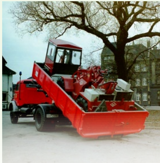
Op een wissellaadbak was de complete machine met toebehoren geplaatst en kon zo snel naar de plaats incident worden gebracht.
