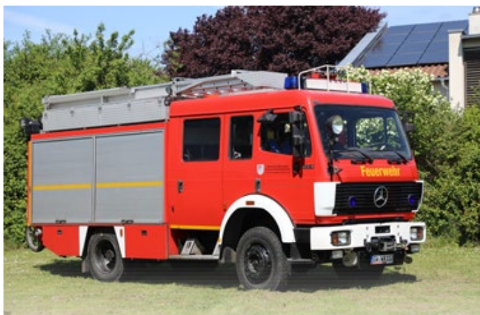
Florian Wackerow 44-01 LF 16/12 Mercedes-Benz 1224AF (1994) FGL-opbouw, Rosenbauer R240 pomp en 1400 liter watertank
